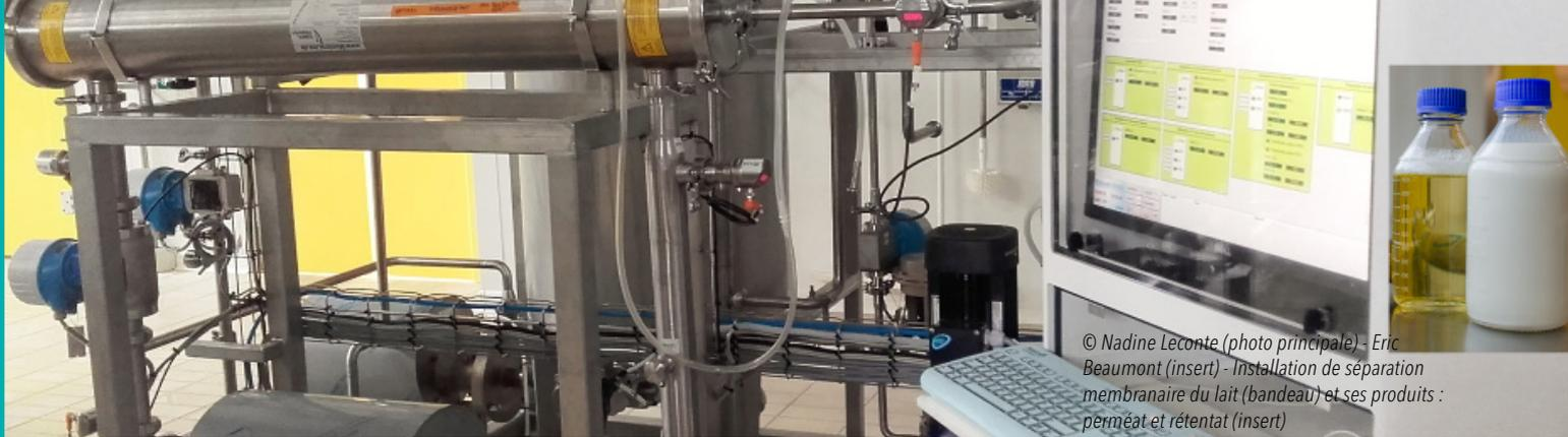
© Nadine Leconte (photo principale) - Eric Beaumont (insert) - Installation de séparation membranaire du lait (bandeau) et ses produits : perméat et rétentat (insert)
