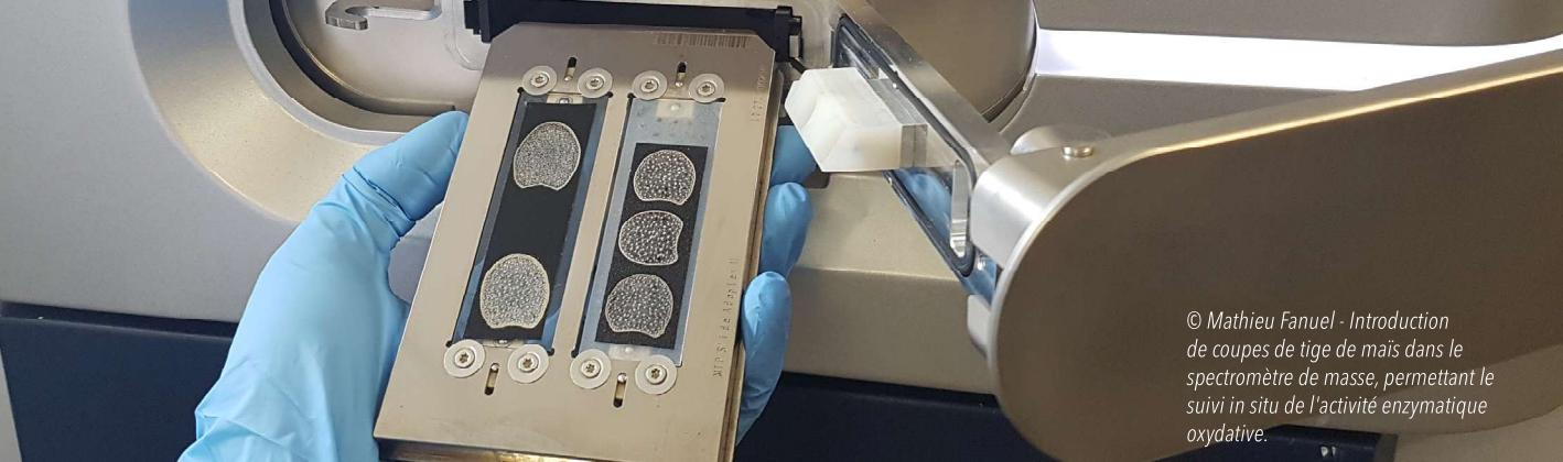
© Mathieu Fanuel - Introduction de coupes de tige de maïs dans le spectromètre de masse, permettant le suivi *in situ* de l'activité enzymatique oxydative.
